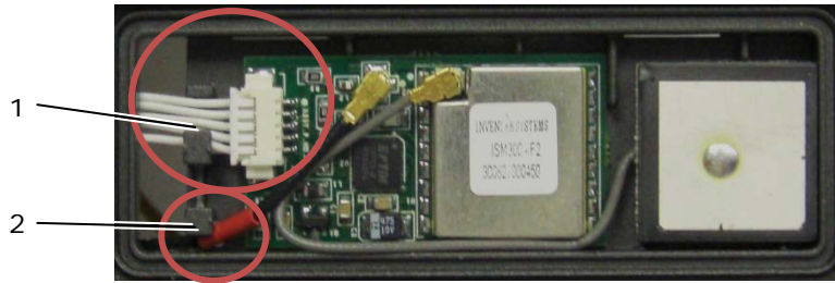
1 USB-kaapelin ohjain 2 GPS-läpivientiantennikaapelin ohjain
